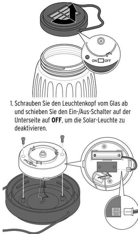
1. Schrauben Sie den Leuchtenkopf vom Glas ab und schieben Sie den Ein-/Aus-Schalter auf der Unterseite auf **OFF**, um die Solar-Leuchte zu deaktivieren.
